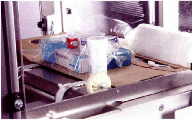
Eine Schrumpffolie fixiert die Versandprodukte auf einen Trägerkarton. Bild: Kraus Maschinenbau
