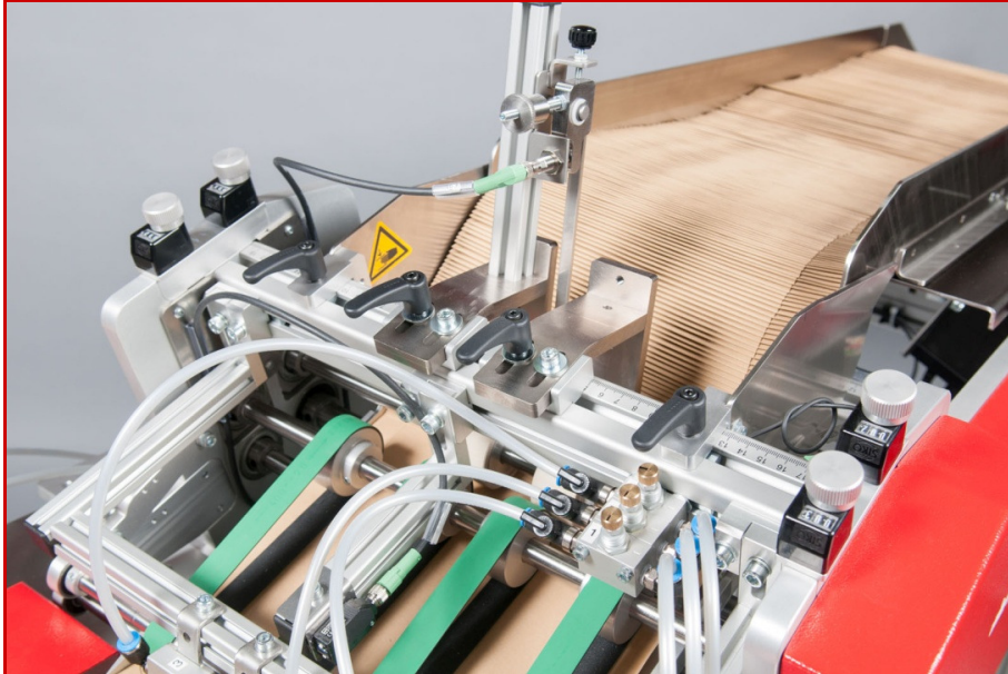
Übergabe der Produkte vom Schuppenzuführband in den Anleger.
