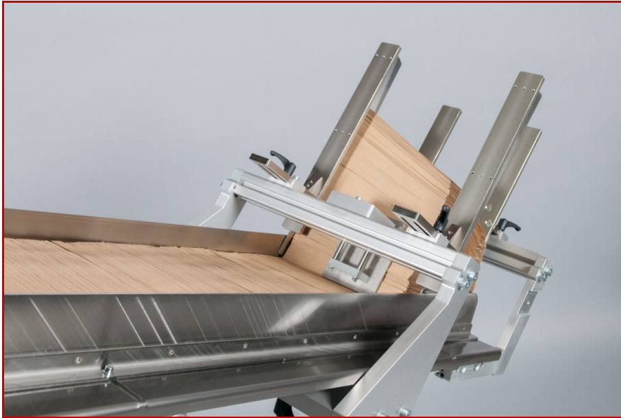
Vertikalmagazinschacht auf dem Schuppenzuführband mit Rückhaltemimik für perfekte Schuppung der Produkte auf dem Band.
