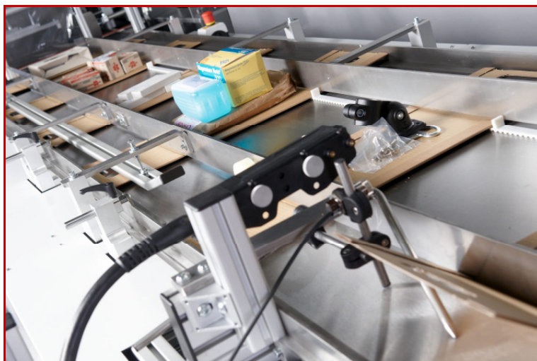
Automatisches Hochklappen des Kartons und aufdrucken des Barcodes mittels Ink-Jet-Drucker
